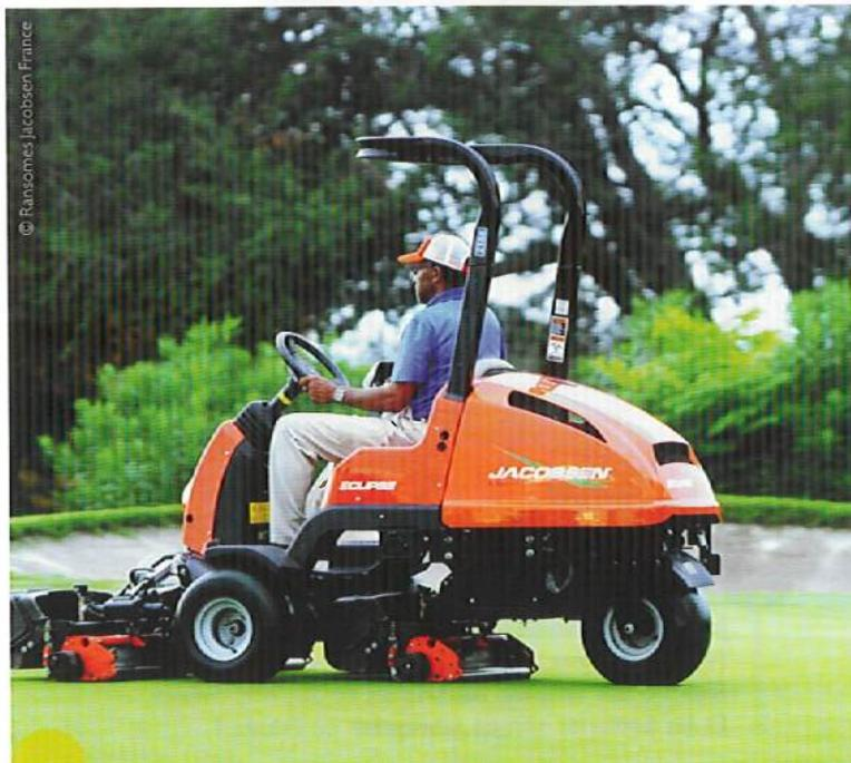
La triplex à batterie Eclipse 360 de Ransomes Jacobsen Elite™ présente une autonomie record : 60 à 60 greens en une seule charge ! Sa fréquence de coupe est programmable, ce qui permet de faire tourner les cylindres en synchronisation avec les roues. Donc si un utilisateur avance plus vite qu'un autre, la vitesse des cylindres augmentera aussi.
