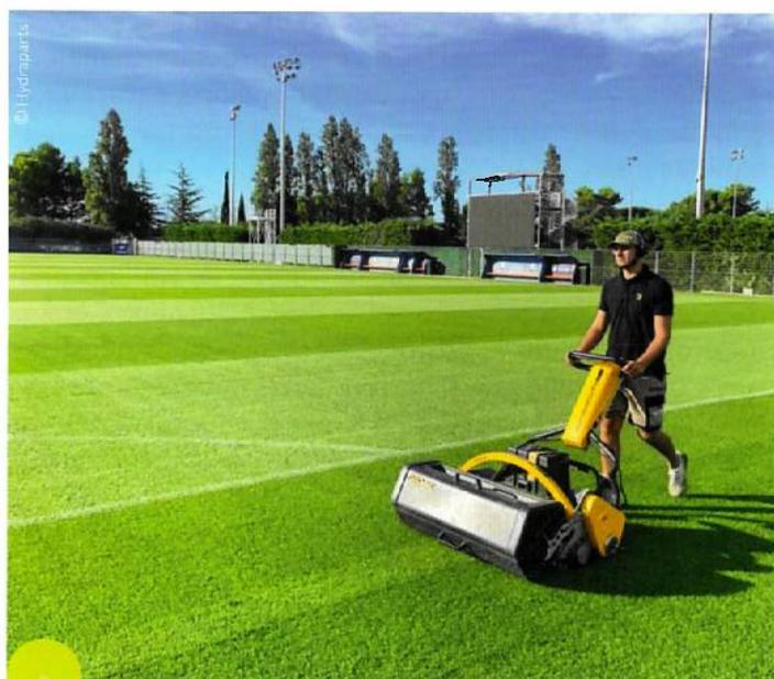
Distribuée par Hydraparts, la simplex à tête flottante Infinicut assure une qualité de tonte constante. Elle possède une batterie lithium de 30 Ah, pour une autonomie théorique d'environ 3 h 45.
