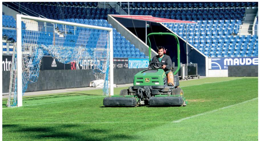
Gemäht wird mit einem Spindelmäher auf einer Schnitthöhe von 30 mm (vor einem Spiel 27 mm). Das Schnittgut wird aufgefangen und entfernt.
